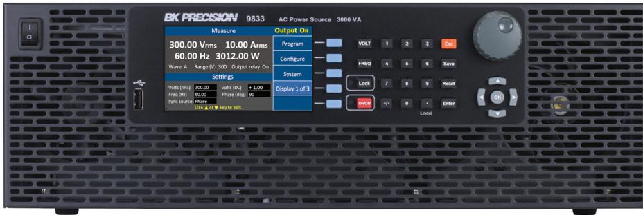
Los modelos de la Serie 9830 son fuentes de alimentación AC monofásicas de baja distorsión que entregan un máximo de 3000 VA, 300 Vrms, 30 Arms / 97.5 Apk con frecuencia de salida ajustable de 45 Hz a 1200 Hz. Alojadas en una unidad compacta, con factor de forma 3U, estas fuentes AC son capaces de generar ambas, salidas AC, DC, y AC+DC.
