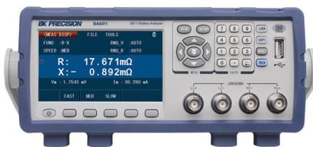
Estos analizadores de baterías utilizan una fuente AC con corriente constante de 1 kHz AC para medir su impedancia, expresada en 11 funciones de mediciones diferentes. Con voltaje básico, exactitud de impedancia de 0.1% y resolución de micro-ohmios, estos instrumentos son ideales para analizar gran variedad de tipos de baterías y configuraciones en ambientes de laboratorio, control de calidad y manufactura.
