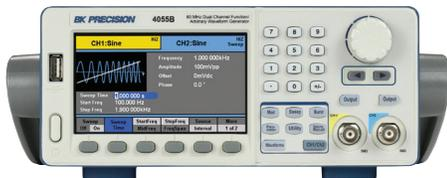
La Serie 4050B son generadores de funciones/formas de ondas arbitrarias canal dual son capaces de proveer formas de ondas seno, cuadradas, triángulo, pulso y arbitrarias estables y precisas de hasta 60 MHz, utilizando la arquitectura DDS.
