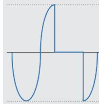
El simulador PLD, permite al usuario producir formas de ondas con las perturbaciones más comunes como caída de voltaje, sobre-tensión e interrupción de la energía eléctrica en posiciones definidas por el usuario en la forma de onda.
